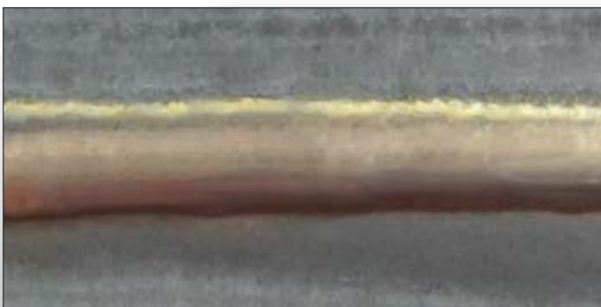
BRASATURA CON FILO CuSi 3 BRAZING WITH CuSi 3 WIRE
