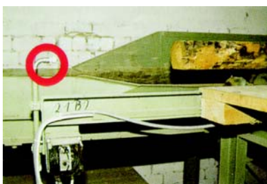
Telco-Lichtschranken an einem Transportband in einem Sägewerk
